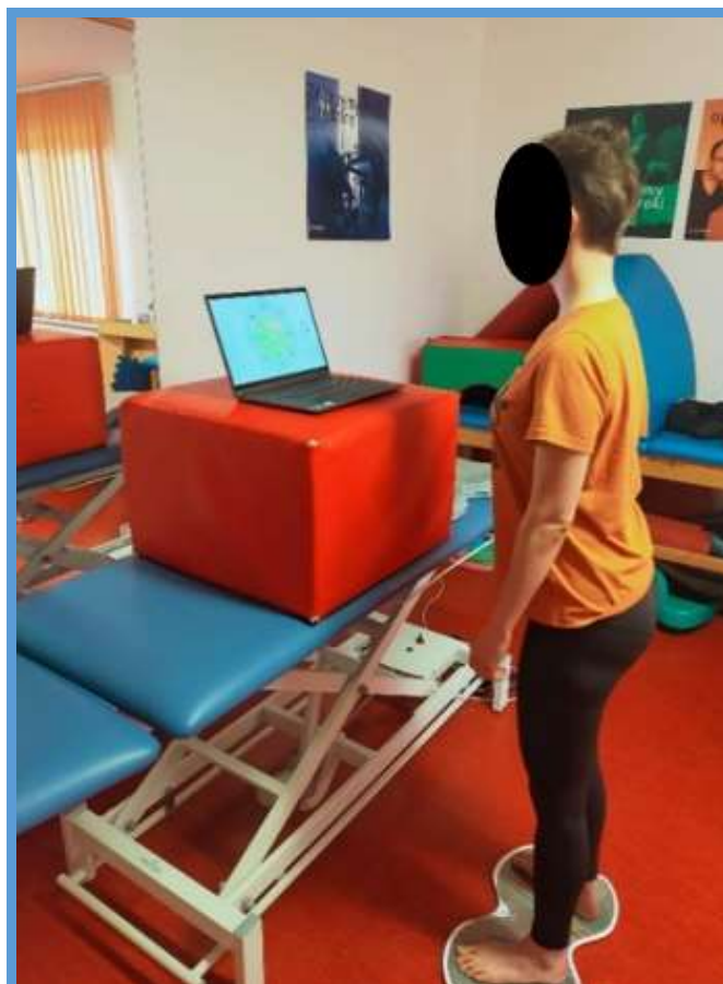
Rycina 15. Metoda oceny ilościowej zaburzeń równowagi za pomocą platformy posturograficznej TYMO® [źródło własne]
