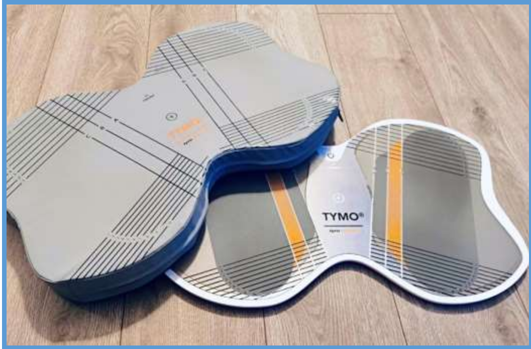
Rycina 14. Platforma posturograficzna TYMO z podkładką [źródło własne]
