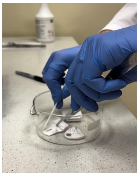
Rycina 5. Proces pobierania materiału z plastikowej części [10]
