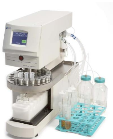
Ryc. 30: Zautomatyzowany system do ekstrakcji do fazy stałej SmartPrepExtractor II.
